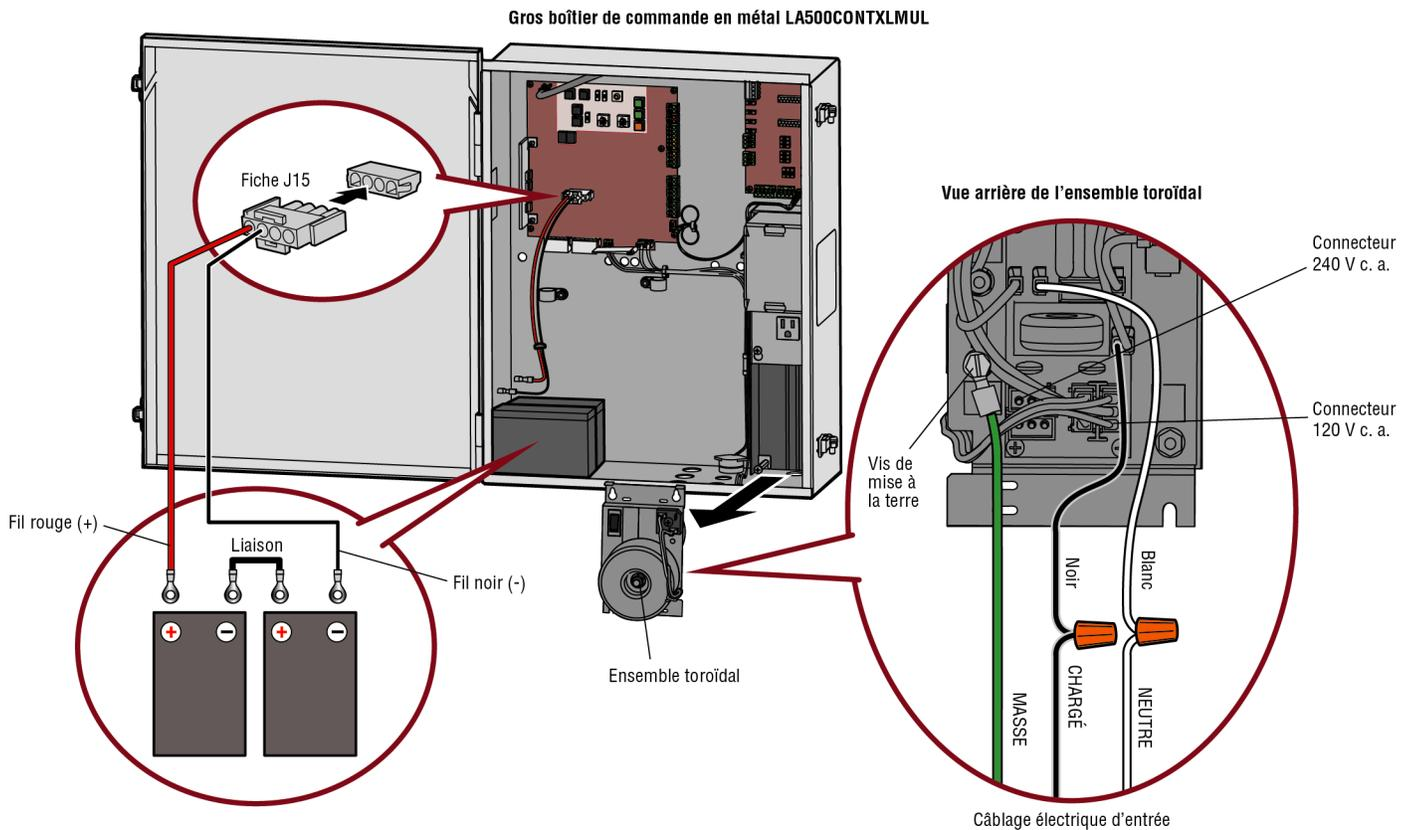
Tous les câbles de commande utilisés pour raccorder des dispositifs externes aux circuits de classe 2 de l'actionneur doivent être des câbles de puissance limitée (QPTZ), de type CL2, CL2P, CL2R ou CL2X ou d'autres câbles présentant des caractéristiques électriques, mécaniques et d'inflammabilité équivalentes ou supérieures.
